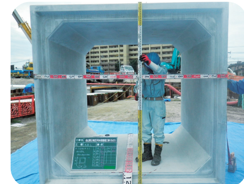
【雨水管きょ】 鉄筋コンクリート製で、縦横の長さが1m程度から3mを超えるものまであり、道路の下などに埋設されています。
