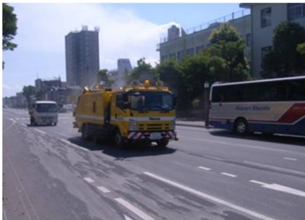
大型車両による降灰除去作業
