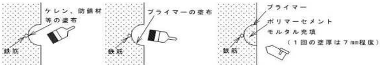
図-1 鉄筋露出の場合(ポリマーセメントモルタル充填工法)
