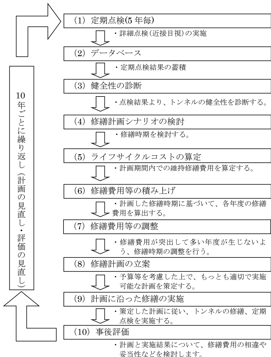
図 4.1.1 トンネル長寿命化修繕計画の流れ
