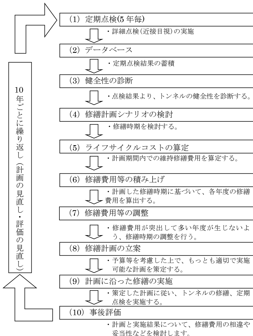
図 4.1.1 トンネル長寿命化修繕計画の流れ
