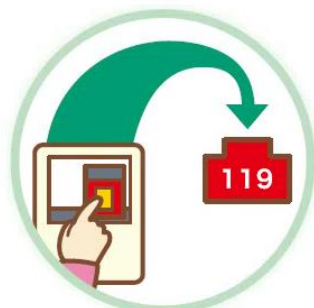
火災通報装置
