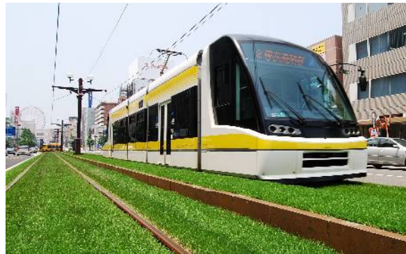
↑市電センターポール&軌道敷緑化
