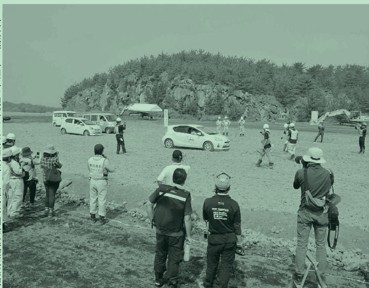
▶大量軽石火山灰を想定した車両走行・道路啓開作業検証実験
