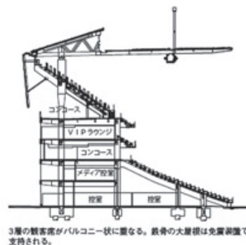
3層構造の断面図
