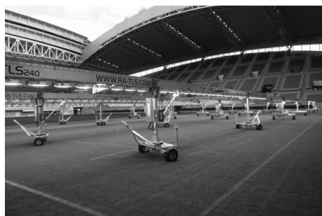
天然芝の生育不足を改善するため、人工的に光をつくり出す「グローライト」 （撮影：鹿児島市議会事務局議事課）
