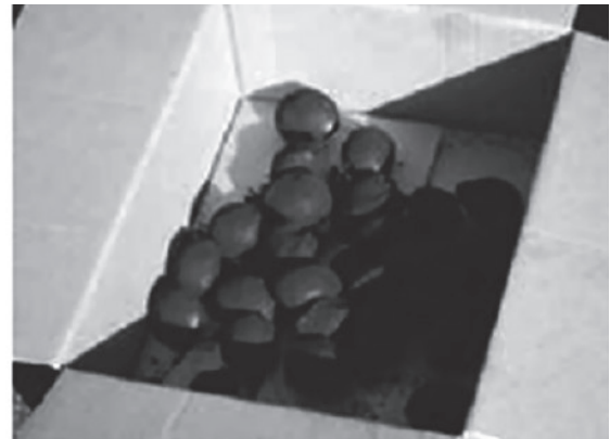
④熱分解後、粉体カーボンがブリケット状に成型され、電気炉で還元剤として使用
